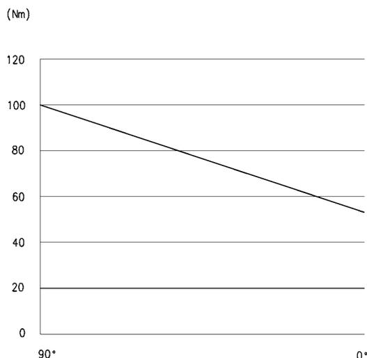
Il grafico mostra lo sviluppo della coppia (in Nm) espressa da un cilindro a semplice effetto durante la manovra di chiusura dell'aria. La manovra parte da 90° per concludersi a 0°. Il valore di coppia sviluppato sarà maggiore a 90° e decrescerà man mano che la corsa si sviluppa, per via dell'azione naturale delle molle che perderanno spinta durante la decompressione. Le molle sono il motore della manovra. Vedi anche TABELLA DEL MOMENTO TORCENTE a pag. 1/6.20.04.
