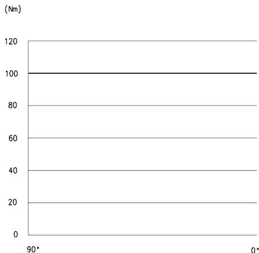
Il grafico mostra lo sviluppo della coppia (in Nm) espressa da un cilindro Serie ARP a doppio effetto durante la manovra di chiusura dell'aria. La manovra parte da 90° per concludersi a 0°. La particolarità del cilindro modello "rack & pinion" sta nel fatto che il valore di coppia espresso si mantiene costante durante tutta la corsa.
