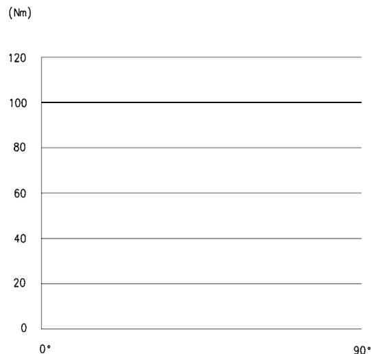
Il grafico mostra lo sviluppo della coppia (in Nm) espressa da un cilindro Serie ARP a doppio effetto durante la manovra di apertura dell'aria. La manovra parte a 0° per concludersi a 90°. La particolarità del cilindro modello "rack & pinion" sta nel fatto che il valore di coppia espresso si mantiene costante durante tutta la corsa.
