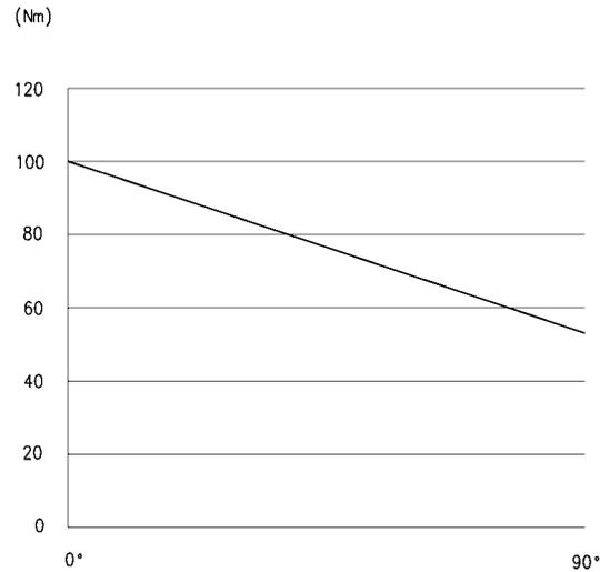
Il grafico mostra lo sviluppo della coppia (in Nm) espressa da un cilindro a semplice effetto durante la manovra di apertura dell'aria. La manovra parte da 0° per concludersi a 90°. Il valore di coppia sviluppato sarà maggiore a 0° e decrescerà man mano che la corsa si sviluppa, per via dell'azione contraria operata dalle molle. L'aria è il motore della manovra. Vedi anche TABELLA DEL MOMENTO TORCENTE a pag. 1/6.20.04.
