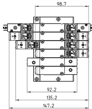
Convogliatori completi di valvole per montaggio su base - passo 19
