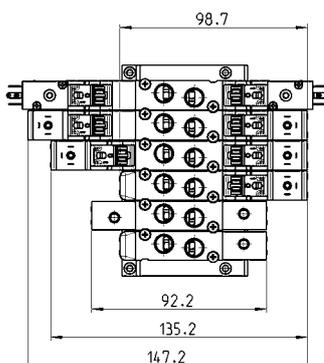
Convogliatori completi di valvole con utilizzi sul corpo - passo 19
