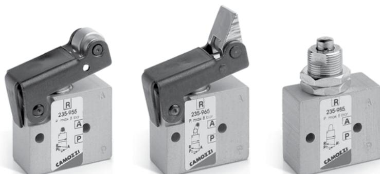
Le valvole miniaturizzate con comando meccanico a 3/2 vie NC della Serie 2 sono disponibili con attacchi filettati M5 oppure con raccordo super rapido per tubi Ø4.
