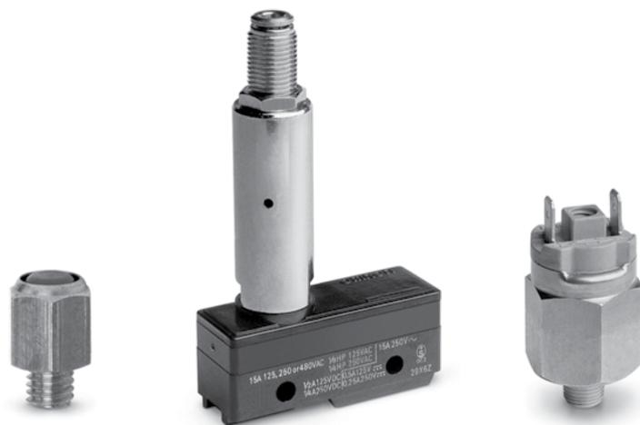
I pressostati a membrana della Serie PM sono disponibili nella versione a contatti NC (normalmente chiusi) o NO (normalmente aperti). Una vite di registro, regolabile con un piccolo cacciavite, permette la taratura alla pressione desiderata. Questi pressostati sono particolarmente adatti come organi di sicurezza. Infatti, attraverso la membrana tarata possono dare o inibire un segnale elettrico in funzione della pressione stabilita.
