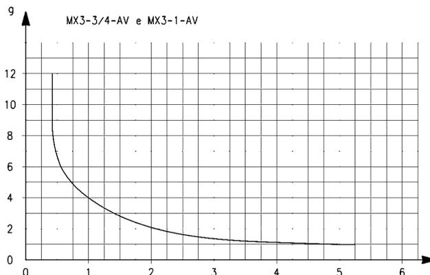
Tempi di pressurizzazione rispetto al n° di giri della vite di regolazione, con volume serbatoio di 5 Litri.
