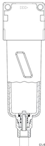
Se si vuole evitare lo scarico della condensa è sufficiente ruotare l'elemento di manovra in senso orario per chiudere completamente lo scaricatore. Utilizzato sulle Serie MC taglie G1/4, G3/8 e G1/2 e Serie N taglie G1/8 e G1/4.
